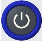
电源开关键/休眠键：单击电源开关键即可使设备开机，在设备运行状态下长按即可关机，单击电源开关键设备进入休眠状态且指示状态灯常亮，再次单击可唤醒。
